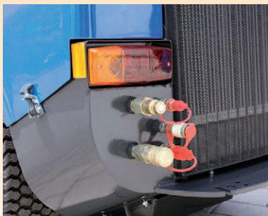
Zadní hydraulické spojky jsou dobře přístupné.
